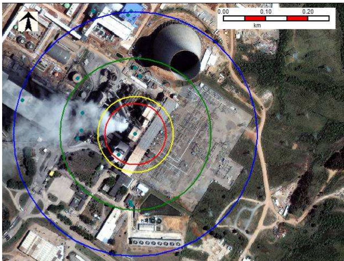
Figura 3.15 - Explosão de mistura de vapor de óleo diesel e ar, no interior da fornalha da Fase B, Hipótese 31B, alcances para sobrepressões de 0,43 bar (vermelho), 0,3 bar (amarelo), 0,1 bar (verde) e 0,05 bar (azul)
