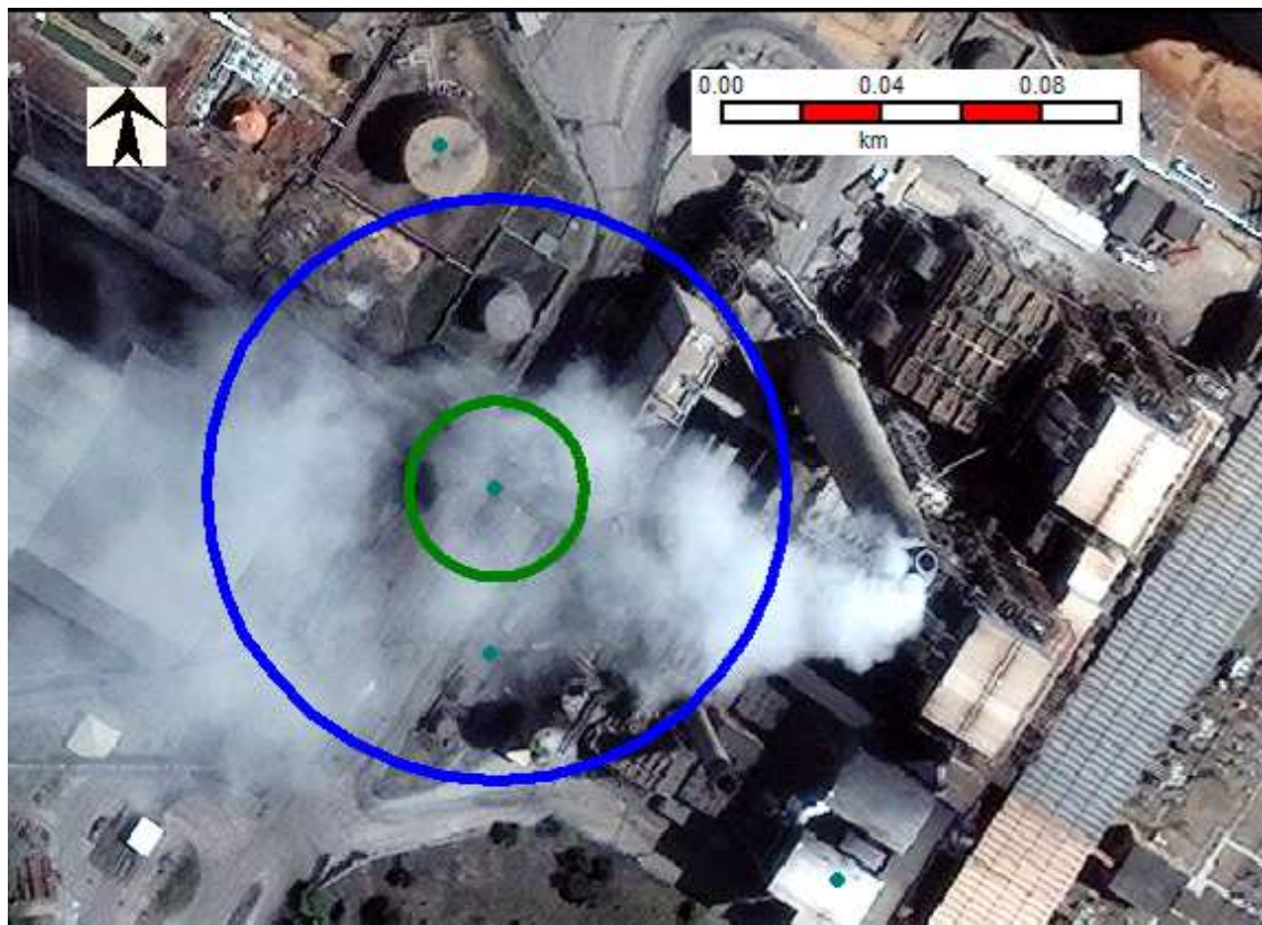
Figura 3.4- Incêndio em poça de combustível, vazamento em linhas do tanque de 5000 m 3 , Hipótese 13 ABC, alcances para fluxos térmicos de 3 kW/m 2 azul) e 12,5 kW/m 2 (verde)
