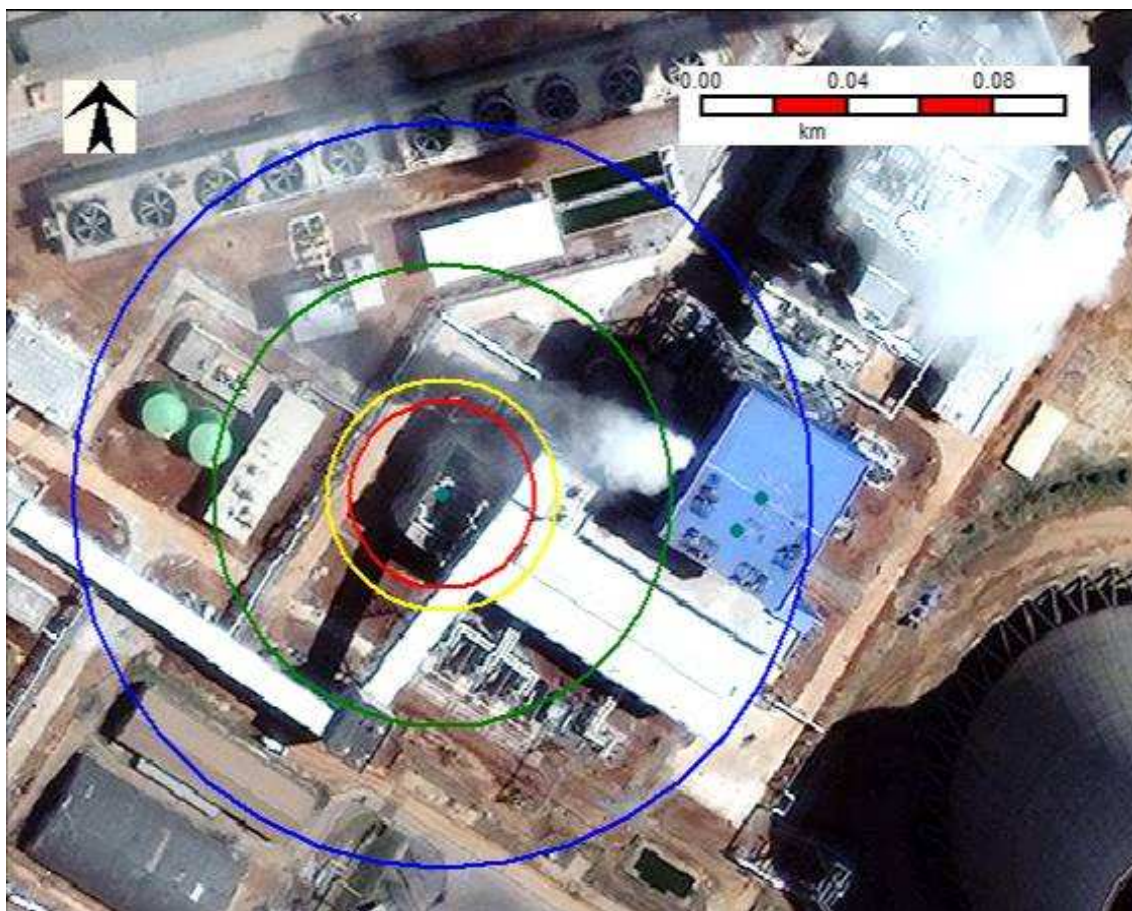
Figura 3.20- Explosão confinada de hidrogênio e ar, Cenário 64C, na sala de baterias, alcances para sobrepressões de 0,43 bar (vermelho), 0,3 bar (amarelo), 0,1 bar (verde) e 0,05 bar (azul)
