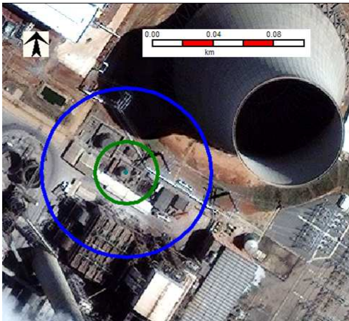
Figura 3.3- Incêndio em poça de diesel, no dique do tanque de 200 m 3 da Fase B, Hipótese 11 B, alcances para fluxos térmicos de 3 kW/m 2 (azul) e 12,5 kW/m 2 (verde)
